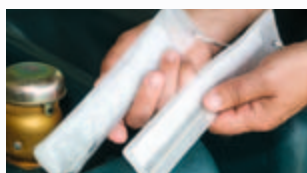
▲ Vann- og partikkelfilter på gardstanken kan spare deg for store problemer.
